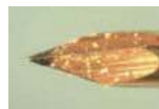
Zanieczyszczenie pokrycia standardowego - twarde złoto, po 0,5 miliona kontaktów.
