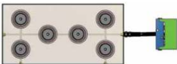
System SMS-i® firmy DADCO z 6 sprężynami gazowymi UH.1600 zintegrowanymi za pośrednictwem otworów wykonanych w płycie i połączone z pulpitem obsługi.
