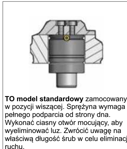
TO model standardowy Kieszon musi mieć płaskie dno. W razie potrzeby konieczne jest włożenie podkładki w celu uzyskania płaskiej powierzchni.
