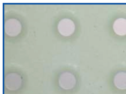
Wykrawane otwory o średnicy 0,05 mm
