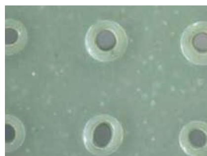
Otwory o średnicy 0,05 mm wykonane laserem
